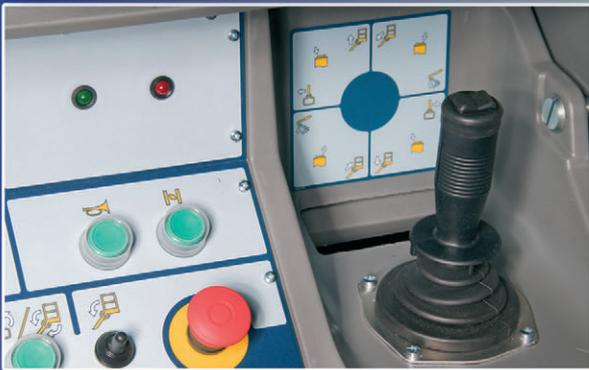
**Stufenlose Steuerung mit einem Joystick**
